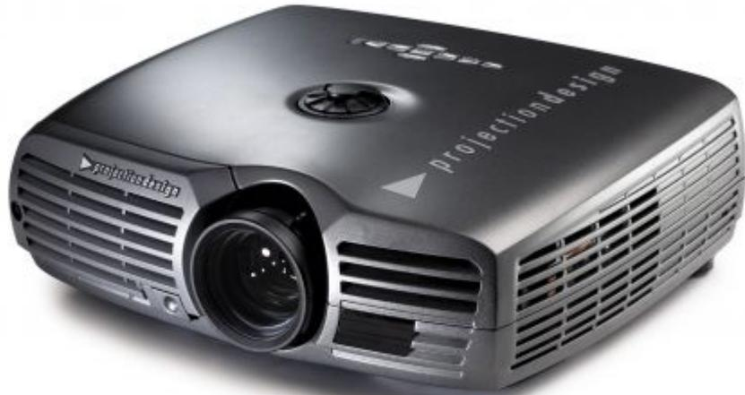
Kurze Vorstellung des projectiondesign F21. Der Standard-Portabel DLP Projektor hat eine HDTV 1920 x 1080 Auflösung und einen Kontrast von 2500:1. Der Projektor bietet auch eine Lens Shift Funktion an, die das Bildeinrichten kinderleicht macht.
