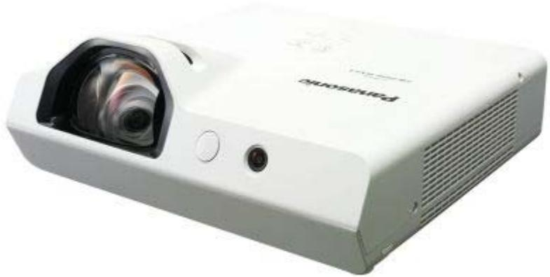
Der PT-TW341R LCD hat 3200 Ansi-Lumen einen Kontrast von 5000:1 und eine WXGA 1280 x 800 Auflösung. Die Lampe ist beim Projektor mit 4000 Stunden Lampenlebensdauer angegeben, was bei einem täglichen schauen von 2 Stunden über 5.5 Jahre wären. Der Projektor bietet auch einen integrierten Mediaplayer an , mit dem sich Dateien dirtekt abspielen lassen. Die horizontale und vertikale Keystone-Korrektur sorgt für Spielraum beim Aufstellen.
